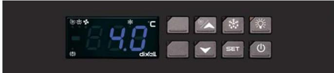
**SET** För kontroll av önskad temperatur samt för att ändra önskad temperatur. I programmeringsläge används den för att kontrollera vald parameter. Den lagrade max-mintemperaturen kvitteras genom att hålla SET intryckt i 3 sekunder när respektive max-minttemperatur visas i termostatens display.
