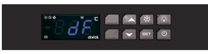
**Obs! Manuell avfrostning nollställer avfrostningstidsräknaren så att de egentliga avfrostningsperioderna kan tidsplaneras med hjälp av den manuella avfrostningen att ske t.ex. utanför rusningstider.**
