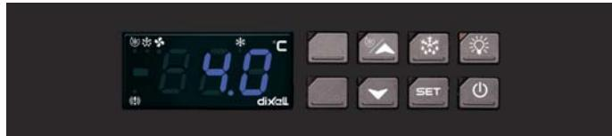
Asetteluarvon näyttö- ja muokkauspainike. Ohjelmointilassa painikkeella valitaan säädetävä arvo tai kuitataan säätötoiminto. Maksimi- tai minimilämpötilan tallentunut arvo voidaan poistaa säätimen muistista painamalla painiketta 3 sekuntia kun lukuarvo näkyy säätimen näytöllä.
