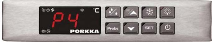
**"P4"** **Tilläggsgivare defekt\*\*\***
