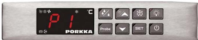
**"P1"** **Termostatgivare defekt\*\*\***
