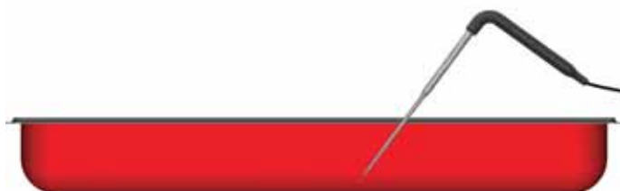
Kuva 2A. Anturi sijoitetaan normaalisti jäähdytettävän massan keskelle.
