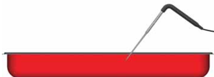
2B. Den Fühler näher an der Oberfläche platzieren, wenn die Gefahr besteht, dass das Produkt einfriert.
