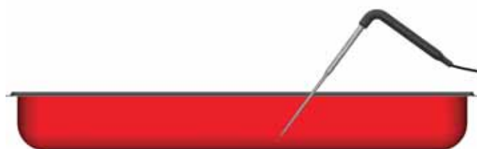
2A. Introduire la sonde au milieu du produit à refroidir.
