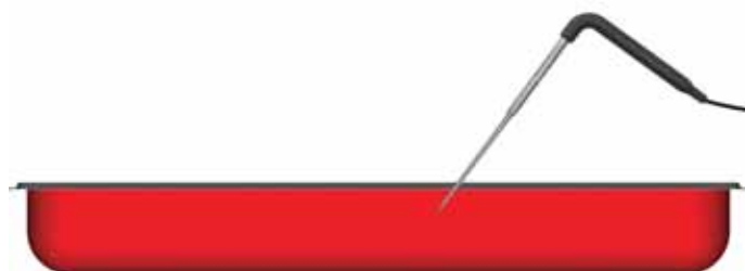
2B. Placer la sonde à la surface du produit quand celui-ci risque de geler.
