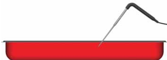
2B. Plaats de sensor meer op de oppervlakte bij het koelen van voedsel welke vlug zou kunnen bevriezen
