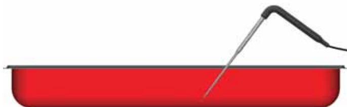
2A. Den Fühler mitten in das zu kühlende Produkt stecken.
