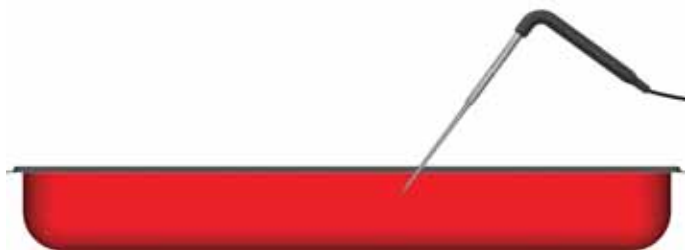
Kuva 2B. Anturi sijoitetaan helposti jäätyvän tuotteen pintaosaan.
