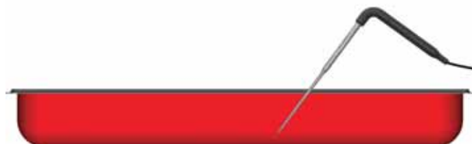
2A. Givaren skall ställas i mitten av massan med normala nedkylningsegenskaper.
