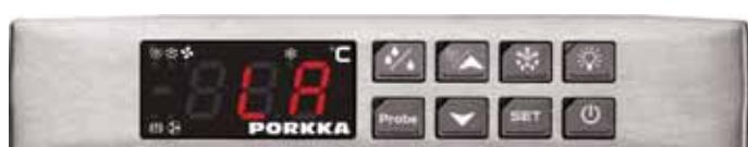
DER AKUSTISCHE ALARM KANN DURCH DRÜCKEN EINER BELIEBIGEN TASTE DER ELEKTRONISCHEN STEUEREINHEIT AUSGESCHALTET WERDEN.
