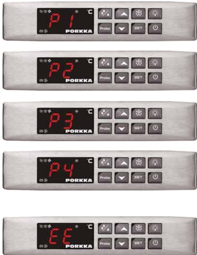
**"P1"**      **Termostatgivare defekt\***
